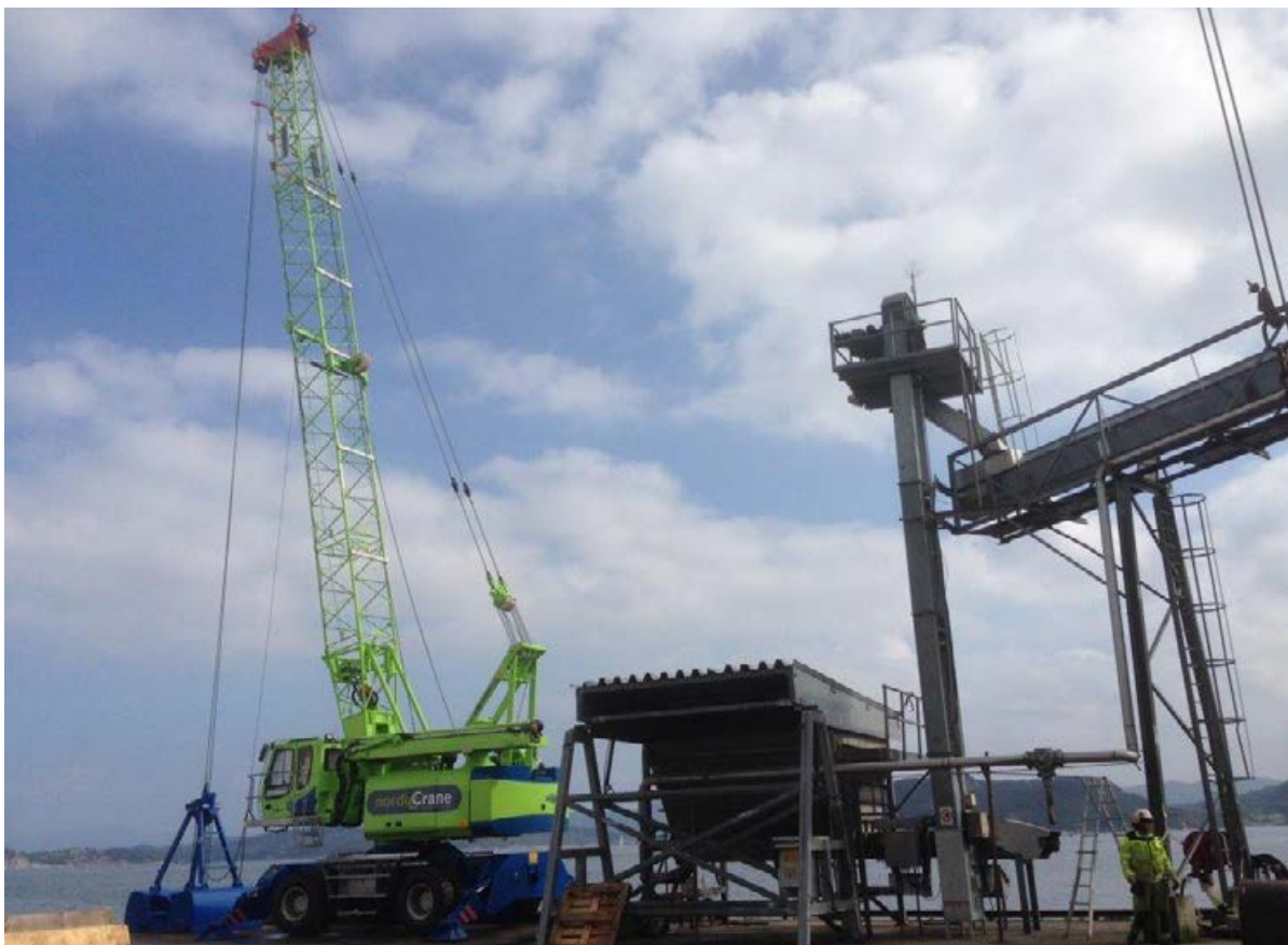
Kranen er en Sennebogen 650 M med grabb som utfører lossearbeid for Skretting AS ved fabrikken deres i Hillevåg.
