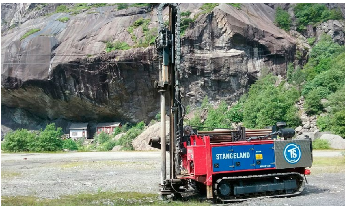
Her er riggen til Kris Rune Skretting på jobben i Jøssingfjord, hvor vi var med og boret 18 testbrønner.
