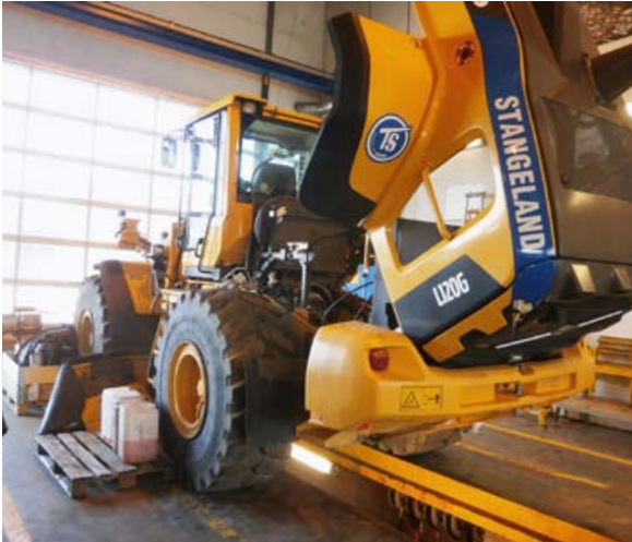
VERKSTEDET: Volvo L120G med demontert motor for overhaling.
