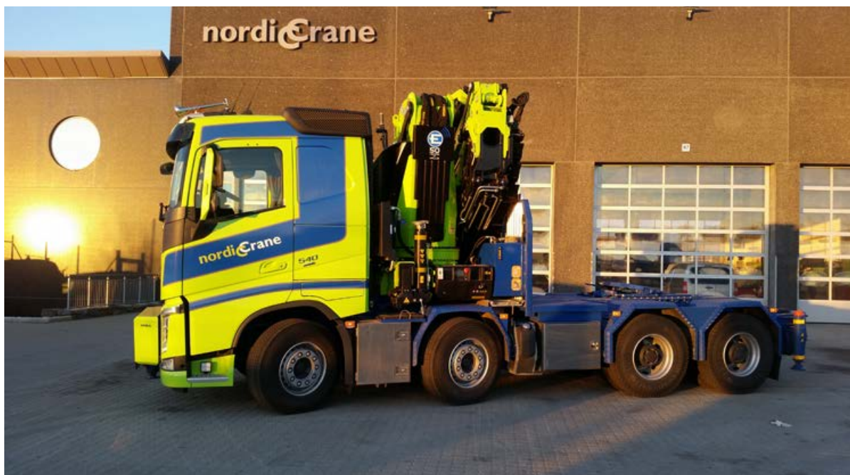
Ny kransemi med 68 tm kran.
