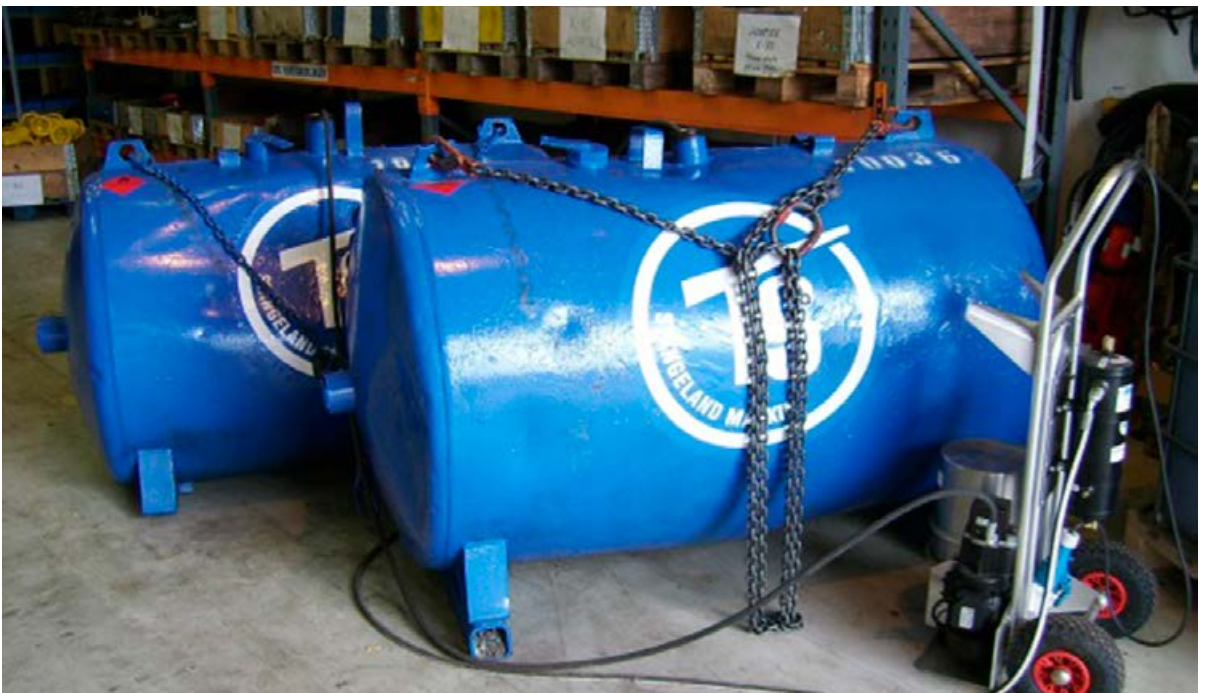
Dieselrensere i gang, her tapper vi fra uren tank gjennom dieselrensere og oppi ren tank. Etter dette vaskes den urene tanken slik den er klar for ny og ren diesel. Dette arbeidet spares inn igjen på mindre tull med injektor havari.
