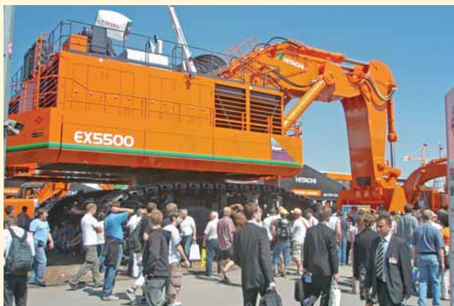
Hitachi 518 tonner med skuffevolum på 29 m 3 .
