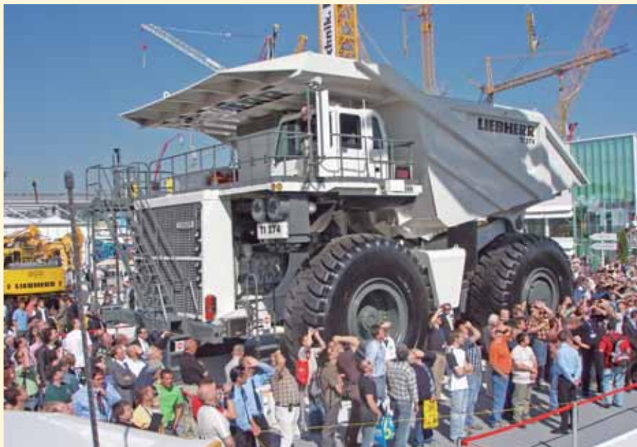
Liebherr-dumper som veide 170 tonn og hadde en lasteevne på 290 tonn/162m 3 .
