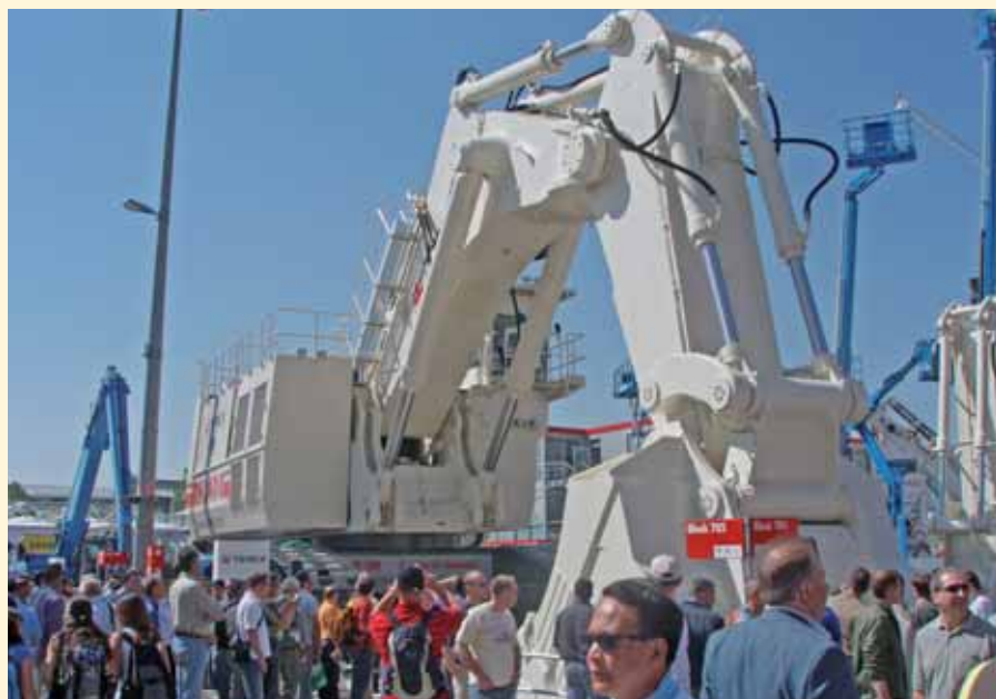
Terex RH340 – en kraftkar på 568 tonn og 34 m 3 skuffe.
