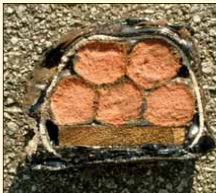
Tverrsnitt av sprengstoffstreng fra krigens dager.
