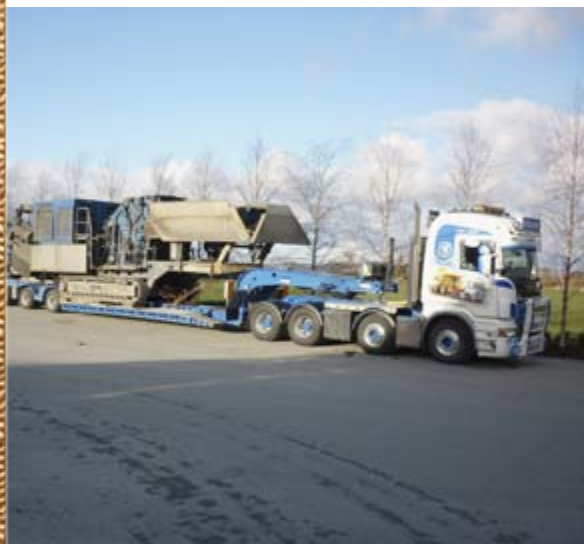
1. asfalt knuser fra nomarka tau til ålesund 17/4-2012 Total vekt 87 tonn Total lengde 27m Bredde 3,5m
