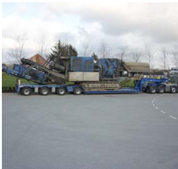
7/4-2012 asfalt knuser fra Normarka Tau til Ålesund via Oslo 110 mil ein veg. Total vekt 87 tonn Total lengde 27 m. Bredde 3,5 m
