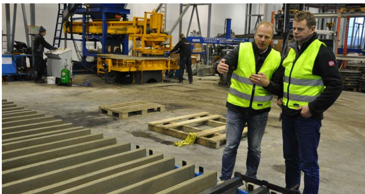
Egil og Sigbjørn er i produksjonshallen til Skjæveland Cementstøperi. Her ser de på produksjon av kabelkanaler til Jernbaneverket. Maskin som nå skal monteres skal blant annet produsere dette produktet og vil da doble produksjonskapasiteten i forhold til dagens produksjonsteknikk.
