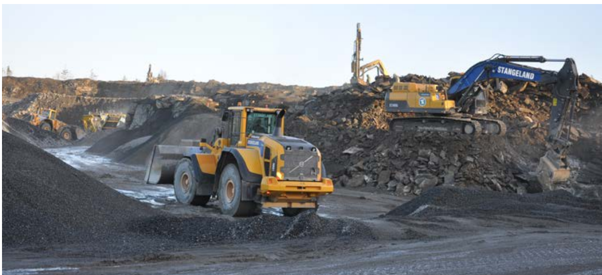
Uttak av fjellmasser på Kverneland Næringspark. Knuses på stedet til grus og pukk. Foto: Leif Emil Egeland.
