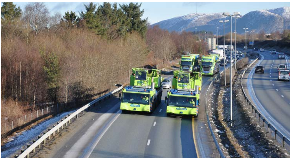
To stk. 500 tonns Liebherr kraner er et sjelden syn. Her på motorveien med hver sin bomtrailer. Hele 9-10 trailerlass må til for å få med alt utstyret for hver kran når de skal flyttes. Foto: Leif Emil Egeland
