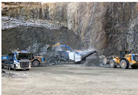
Pukkverk Nordre Kalberg, grovknusing med nyinnkjøpt Kleemann MOBICAT MC 120 Z grovknuser, i gravemaskinen Arve Kenneth Thorsen. Hjullaster til høyre: Thomas Tangedal, hjullaster til venstre: Johannes Høyenes, og i lastebilen Frode Tollefsen.
