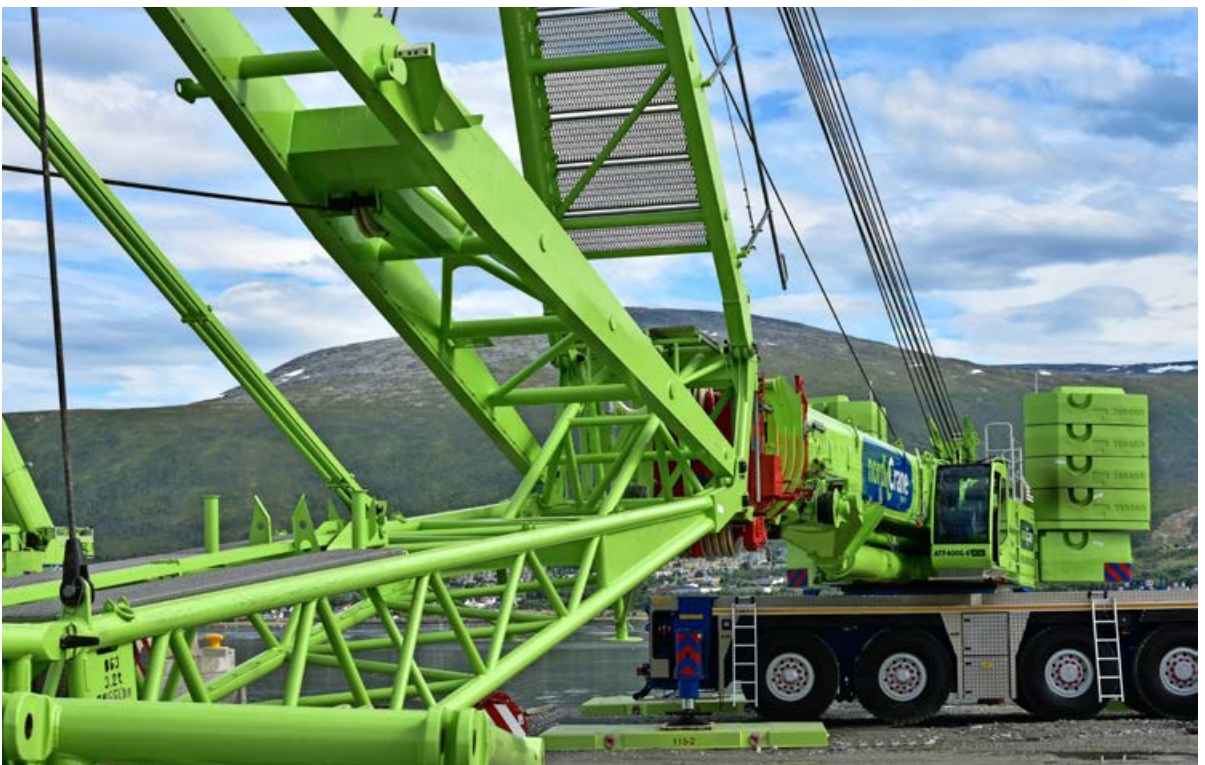
Rigging av ny Tadano 400-tonner i Nord.
