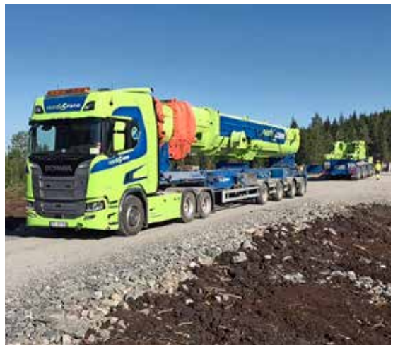
Transport av bommen til en av de to 500 tonnerene som var i aksjon sammen med en 220 tonner i montering av vindmøller i Ørje Vindpark, Østfold.
