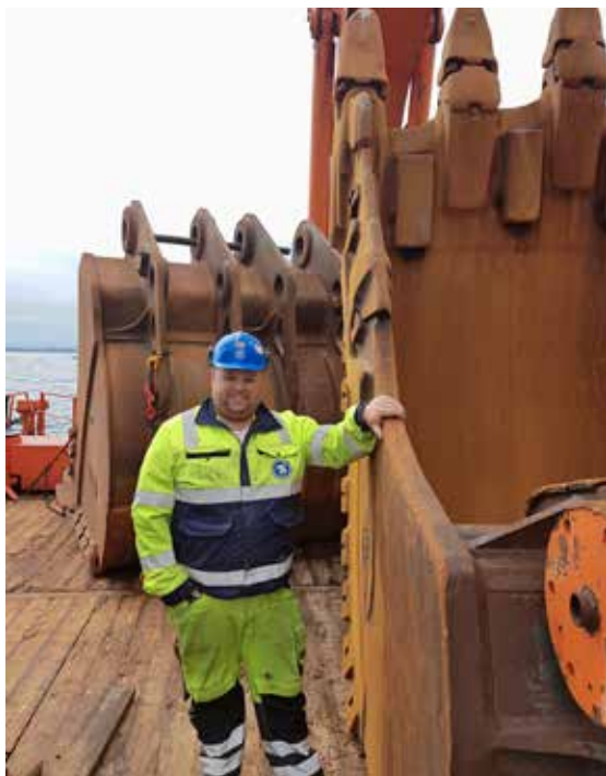
Driftsleder Tor Harald Øglænd om bord på Transporter052 som har en 250mT gravemaskin om bord. Skuffa han står ved siden av er den vi skal bruke på arbeidet og er en 8m3 skuffe.
