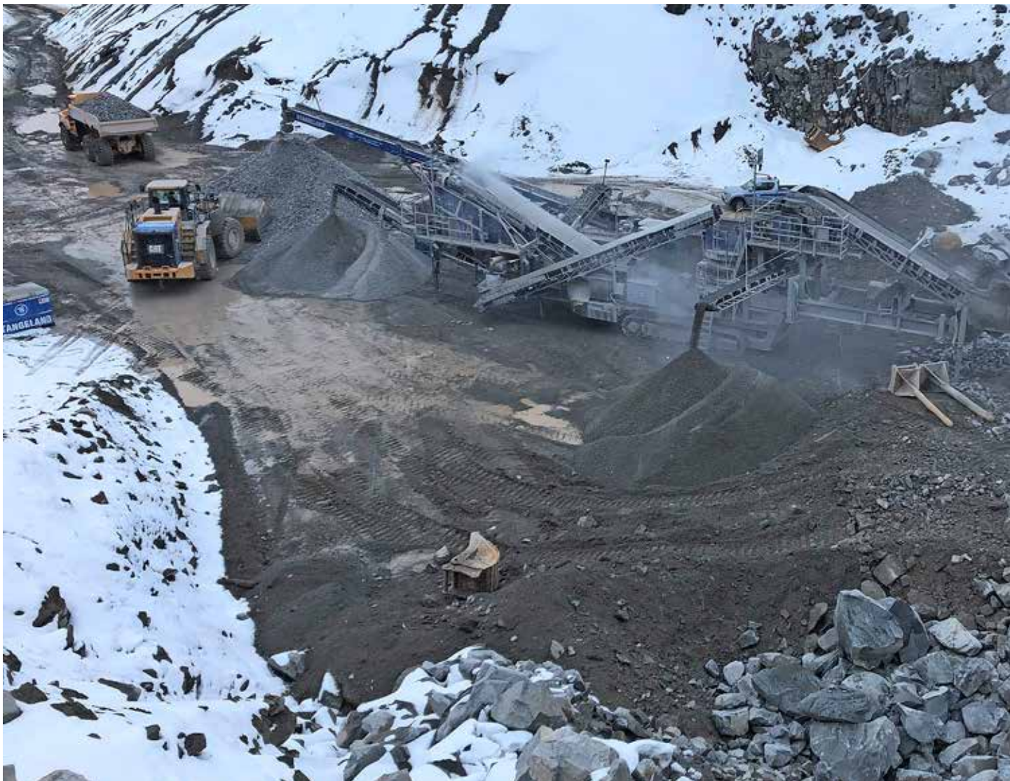
En Cat352 står på utlasting på toppen av fjellet, en Cat352 laster i knuseren. Knusesettet består av en grovknuser Jonsson L1211, en spindel Johnsson LS5500 og en stacker som leder ferdigvarene i hver sin retning.
