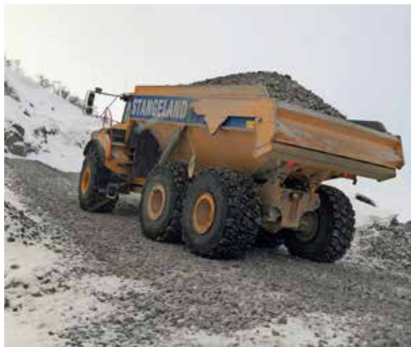
Dumperen kjører opp med nytt lass til depot. Hellingen i vegen er 19 grader, og alt under de snødekte haugene er lagret ferdigvare.
