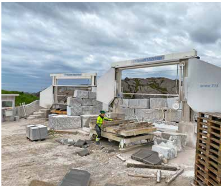
Her i bruddet til Egersund Granitt på Hellvik bearbejder Borsheim vrakstein etter uttak av de eksklusive steinblokkene Labrador Brown Pearl. Blokkene sages ned i mindre dimensjoner for videre bearbeiding.
